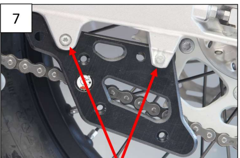
7 Use OEM screws Utiliser les vis d'origine
