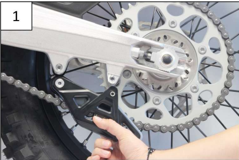
1 Remove the OEM chain guide Enlever le guide chaîne d'origine
