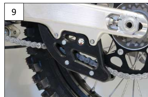
Place the second bloc, clip it and tight with the Tfhc 6x60mm screws, M6 Washers and em6f Placer le second bloc, clipser et serrer le tout avec les tfhc 6x60 + Rondelles M6 et les Em6f
