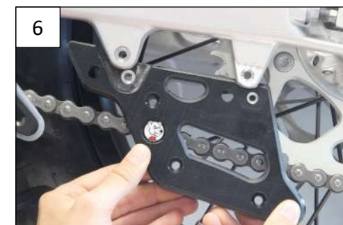
Place the alloy smooth spacer as indicated on the pictures Placer l'entretoise lisse comme indiqué sur les photos
