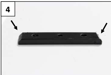
The 8mm plate has to be placed with the chamfered sides going inside of the frame and will be fixed by auto drilling in the 20mm part. La plaquette 8mm doit être placée avec les côtés chanfreinés à l'intérieur du cadre et fixée par auto perçage dans la bride 20mm
