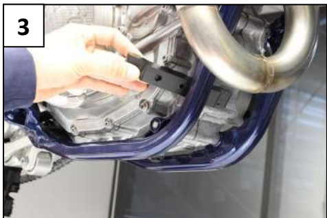
Place the front bracket by the side Placer la fixation par le côté
