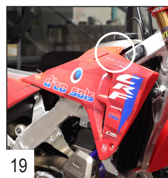
19 Repeat the operation on the other side, then put the plastics back using the OEM screws on top. Répétez l'opération de l'autre côté puis remettez les plastiques en place en utilisant les vis d'origine.
