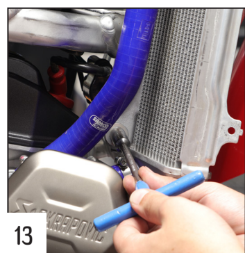
13 Use a TH 6x30mm screw to fix it behind the radiator and tighten. Utilisez une vis TH 6x30mm pour la fixer derrière le radiateur.
