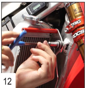
12 Use a TH 6x30mm screw to keep it in place. Utilisez une vis TH 6x30mm pour le maintenir en place.
