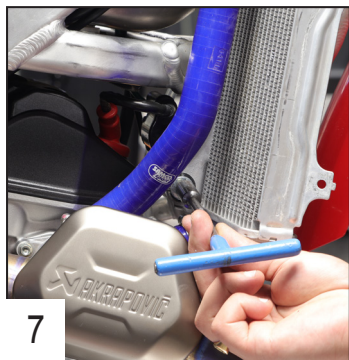
7 Remove the OEM screw that maintain the radiator in place. Enlever la vis d'origine à l'arrière du radiateur.
