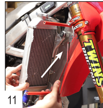
11 Place the protection behind the radiator. Placez la protection derrière le radiateur.
