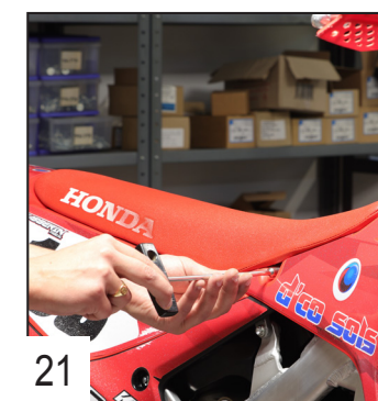
21 Before putting the seat back in place, attach the elastic to the tank and use the OEM screw. Avant de remettre la selle en place, rattachez l'élastique du réservoir puis utiliser la vis d'origine.
