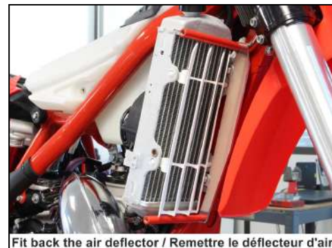
Fit back the air deflector / Remettre le déflecteur d'air
