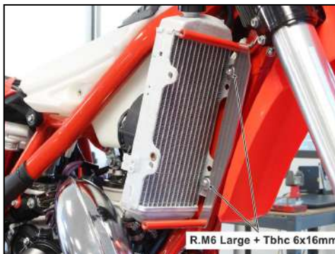
Fit back the air deflector / Remettre le déflecteur d'air
