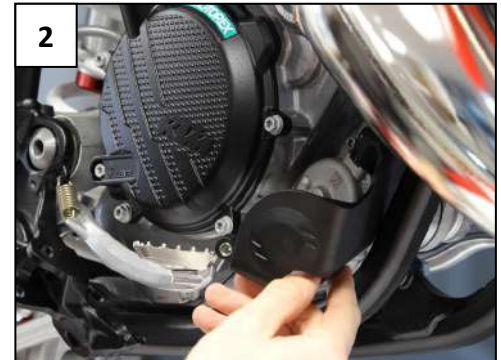
2 Remove the OEM plastic Retirer la cache plastique
