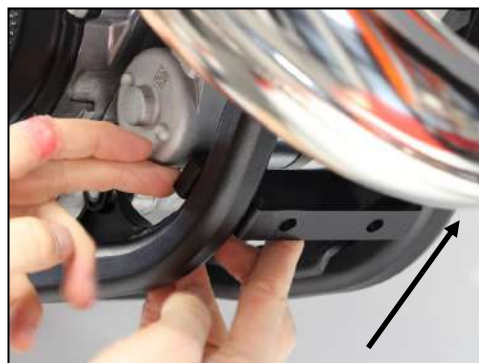
3 Move it to the top until it's blocked Faire remonter la bride jusqu'à ce qu'elle soit bloquée
