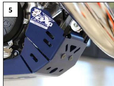
5 Fit the front screws Mettre les vis avant en place
