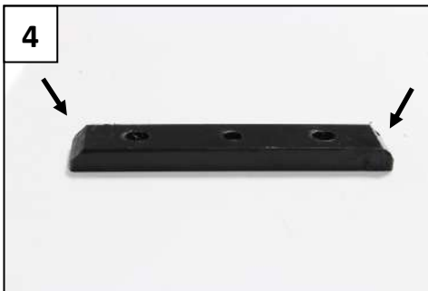
4 The 8mm plate has to be placed with the chamfered sides going inside of the frame and will be fixed by auto drilling in the 20mm part. La plaquette 8mm doit être placée avec les côtés chanfreinés à l'intérieur du cadre et fixée par auto perçage dans la bride 20mm
