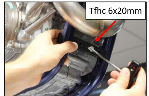
4 The 8mm plate has to be placed with the chamfered sides going inside of the frame and will be fixed by auto drilling in the 20mm part. La plaquette 8mm doit être placée avec les côtés chanfreinés à l'intérieur du cadre et fixée par auto perçage dans la bride 20mm
