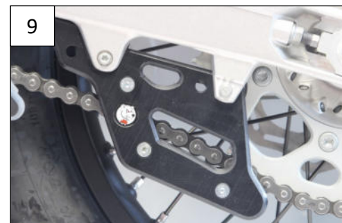
Place the second bloc, clip it and tight with the Tfhc 6x55mm screws, M6 Washers and em6f Placer le second bloc, clipser et serrer le tout avec les tfhc 6x55 + Rondelles M6 et les Em6f
