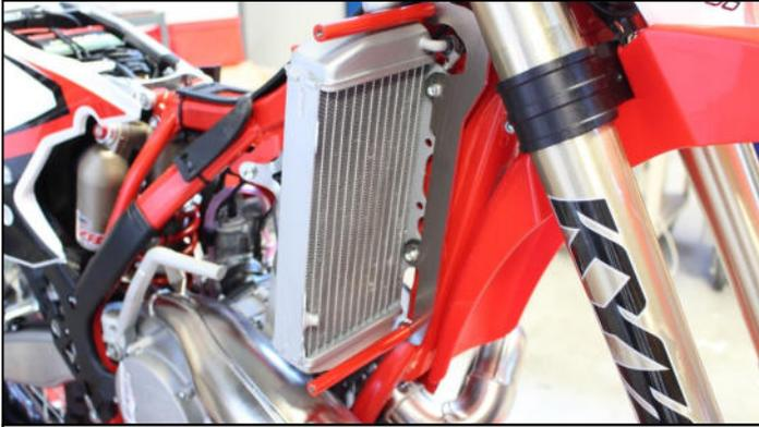
Démonter le réservoir et déflecteur d'air pour fixer l'ensemble avec vis d'origine
